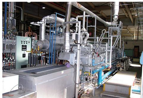
図1. メッシュベルト式連続熱処理炉
